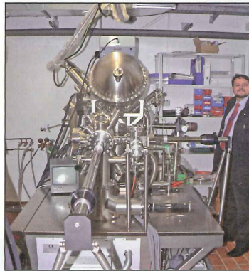
Die Ultrahochvakuum-Anlage von Omicron ermöglicht neben verschiedenen spektroskopischen Methoden auch die Untersuchung von Nanostrukturen mit Rastersondentekniken im Ultrahochvakuum
