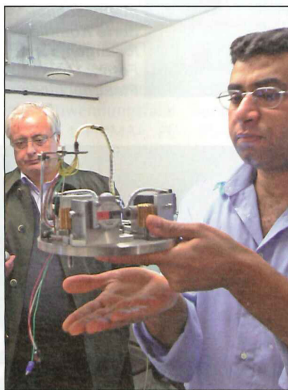
Dr. S. Zein El Abedin Zoubi stellte während der Institutsbesichtigung einen von der TU Clausthal entwickelten Messkopf für die Rastertunnelmikroskopie in ionischen Flüssigkeiten vor. Damit werden beispielsweise halbleitende Eigenschaften von elektrochemisch hergestellten Silizium-Nanostrukturen direkt während der Herstellung der Nanostrukturen bestimmt. Fotos: NMN
