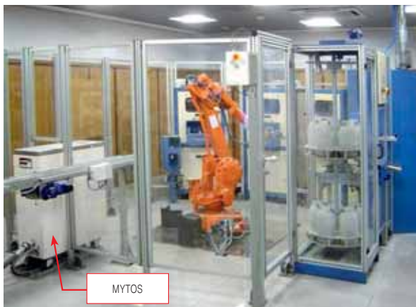
Рис. 4. Автоматизированная цементная лаборатория, включающая анализатор размеров частиц at-line MYTOS и VIBRI
