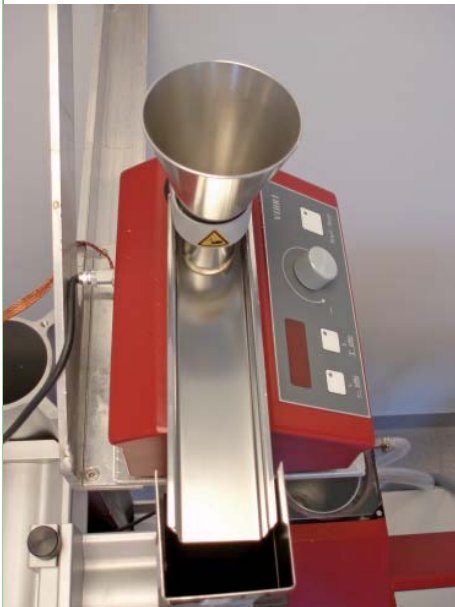
Sympatecs HELOS-instrument med indføringsenheden til tørre prøver (med en tragt og sliske) til venstre samt modulet til våde prøver i midten (kuvette og betjeningspanel) og kuvetten yderst til højre. (Fotos: Charlotte Rasmussen)
