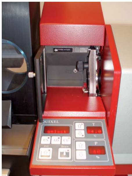
Sympatecs HELOS-instrument med indføringsenheden til tørre prøver (med en tragt og sliske) til venstre samt modulet til våde prøver i midten (kuvette og betjeningspanel) og kuvetten yderst til højre. (Fotos: Charlotte Rasmussen)
