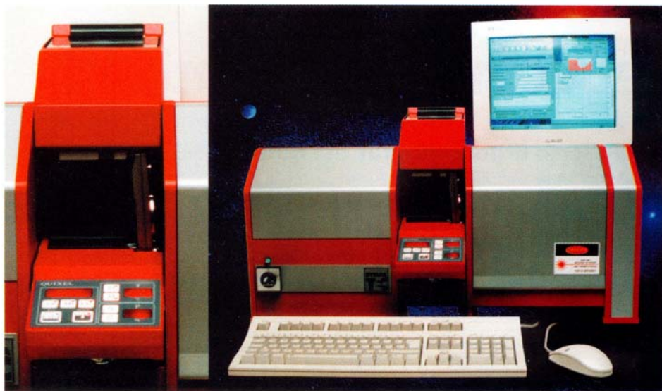
Abb. 3 Das automatische Dispergiemodul Quixel ermöglicht eine schnelle Partikelgrößenanalyse von Suspensionen und Emulsionen
