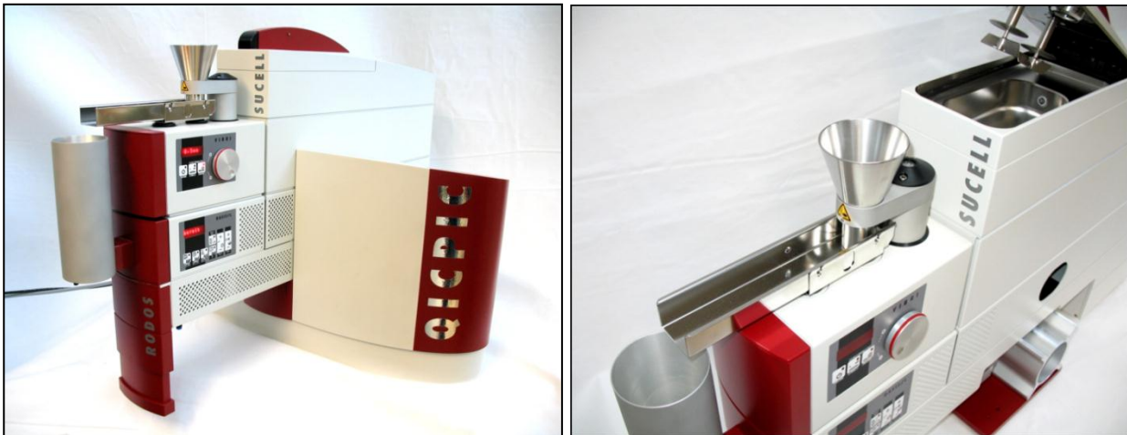
Abb. 30: Links: QICPIC mit Trocken – und Nassdispergiererkombination OASIS. Auf dem RODOS steht der Vibrationsdosierer VIBRI. Rechts: Draufsicht auf das 400 ml Becken mit den Rührern im aufgeklappten Deckel.
