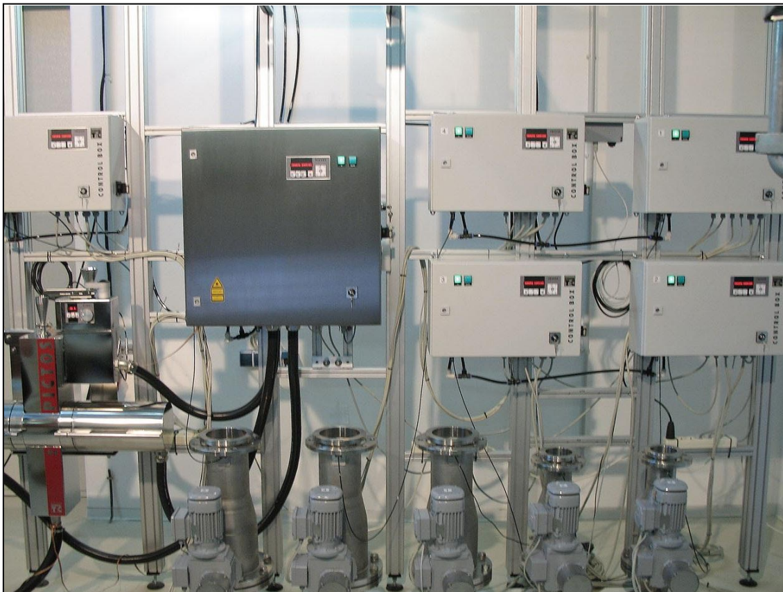
Abb. 33: Das Bild zeigte einen PICTOS in der Endmontage samt Versorgungseinheit (zweite Box von links), der zyklisch mit Proben von drei TWISTER 150 und zwei TWISTER 100 versorgt wird.
