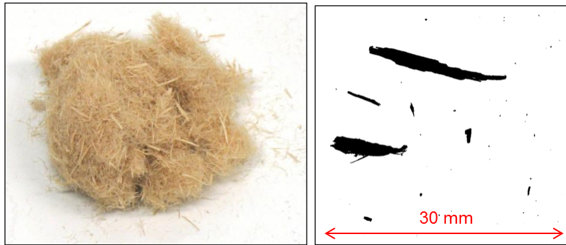
Abb. 26: Links das Aufgabegut (Holzwolle), rechts ein Binärbild der mit FIBROS dispergierten Fasern.
