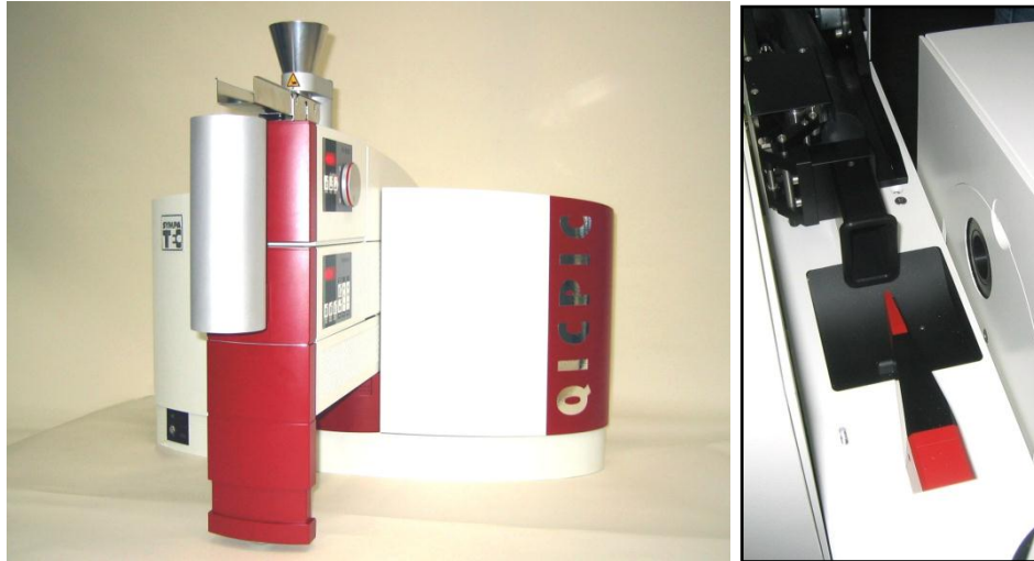
Abb. 17: Links: Hochgeschwindigkeits-Bildanalyse-Sensor QICPIC mit Trockendispergierer RODOS und Vibrationsdosierer VIBRI (oben links). Die Partikel werden die Rinne entlang gefördert, fallen in den zylinderförmigen Trichter, passieren die Dispergierstrecke des RODOS; rechts: Blick in die geöffnete Messzone des RODOS. Die Partikel verlassen dispergiert den Injektor an der roten Spitze, werden von links mit 1 ns-Pulsen beleuchtet und von dem runden Objektiv rechts auf den Kamera-Chip innerhalb des QICPIC-Gehäuses abgebildet.
