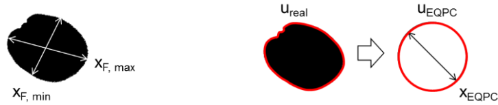
Abb. 12: Links zeigt die Definition des Seitenverhältnisses: \psi_a = x_{F, min} / x_{F, max} ; rechts die Definition der Sphärizität: \psi_s = u_{EQPC} / u_{real}
